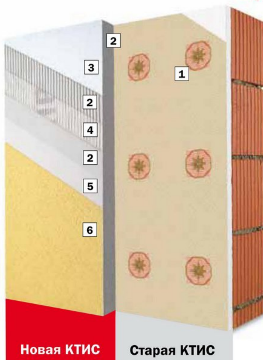
Двойная обшивка с помощью технологии Duplex Baunit
