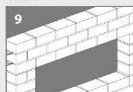
9 Опалубка демонтируется через 2 недели
