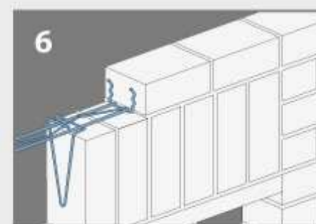
6 В каждом втором вертикальном шве второго ряда монтируются хомуты SU 50-45. Подробнее о монтаже хомутов на стр. 12
