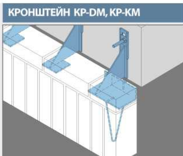
Правый и левый конечные кронштейны, допускающие подвешивание нижнего ряда кладки
