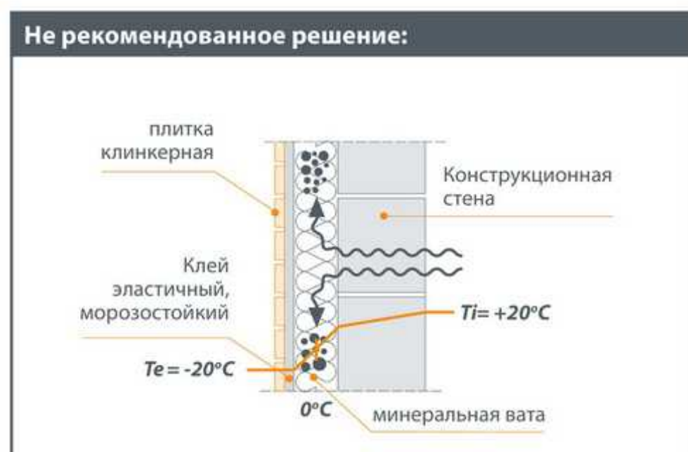
Распределение температур и влажности в утепленных минеральной ватой вентилируемых и невентилируемых стенах
