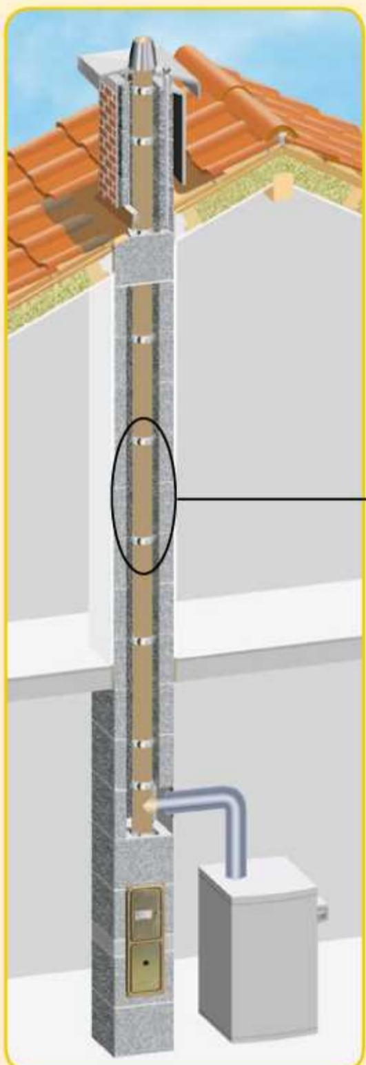
**Эта система относится к системам воздух-газ (LAS) и представляет собой концентрическую конструкцию, в которой по внутренней керамической трубе дымовые газы отводятся в атмосферу, а воздух, необходимый для горения, подводится в пространство между бетонной оболочкой и керамической трубой.**
