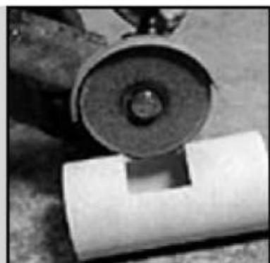
24. Угловой шлифовальной машиной выполните надрезы на поверхности трубы. Не рубить и не сверлить ударной дрелью!!!
