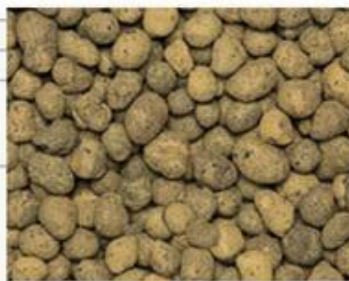
Пористый наполнитель для легких бетонов (керамзитобетон)
