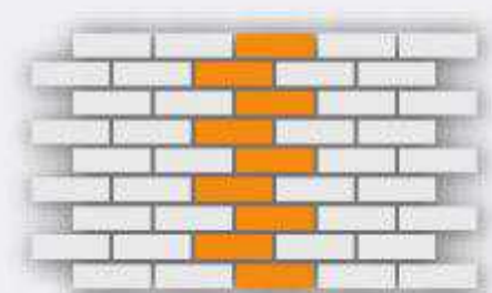
Кладка со смещением – смещение на полкирпича
