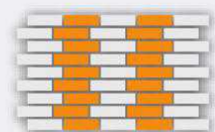
Кладка со смещением – смещение на четверть кирпича
