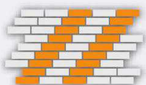
Ложковая кладка - косое смещение на 1/4 кирпича
