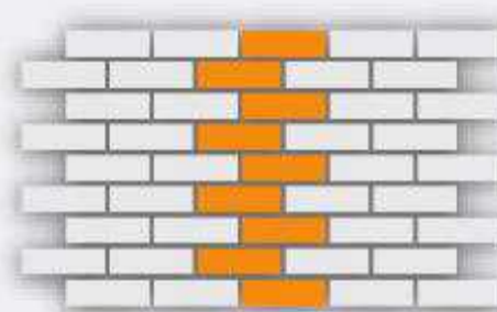
Ложковая кладка - смещение на 1/2 кирпича
