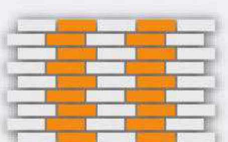
Ложковая кладка - смещение на 1/4 кирпича
