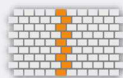
Кладка с выступом части кирпича
